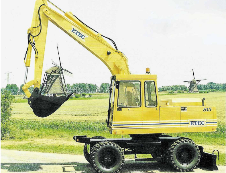
Dem ETEC-Mobilbagger M 815 konnte eine Ähnlichkeit zu ursprünglichen Maschinen von Eder nicht abgesprochen werden. Zumindest die Kabine wurde baugleich übernommen. Foto: Werkbild, Archiv Ulf Böge
