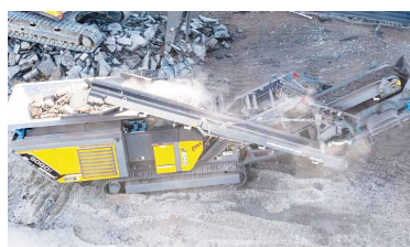
Der Prallbrecher zerkleinert Asphalt, der im Straßenbau wieder einsetzbar ist.
