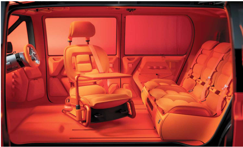
Der gezielt zentral ausgerichtete Fahrersitz lässt sich um 360 Grad drehen.
