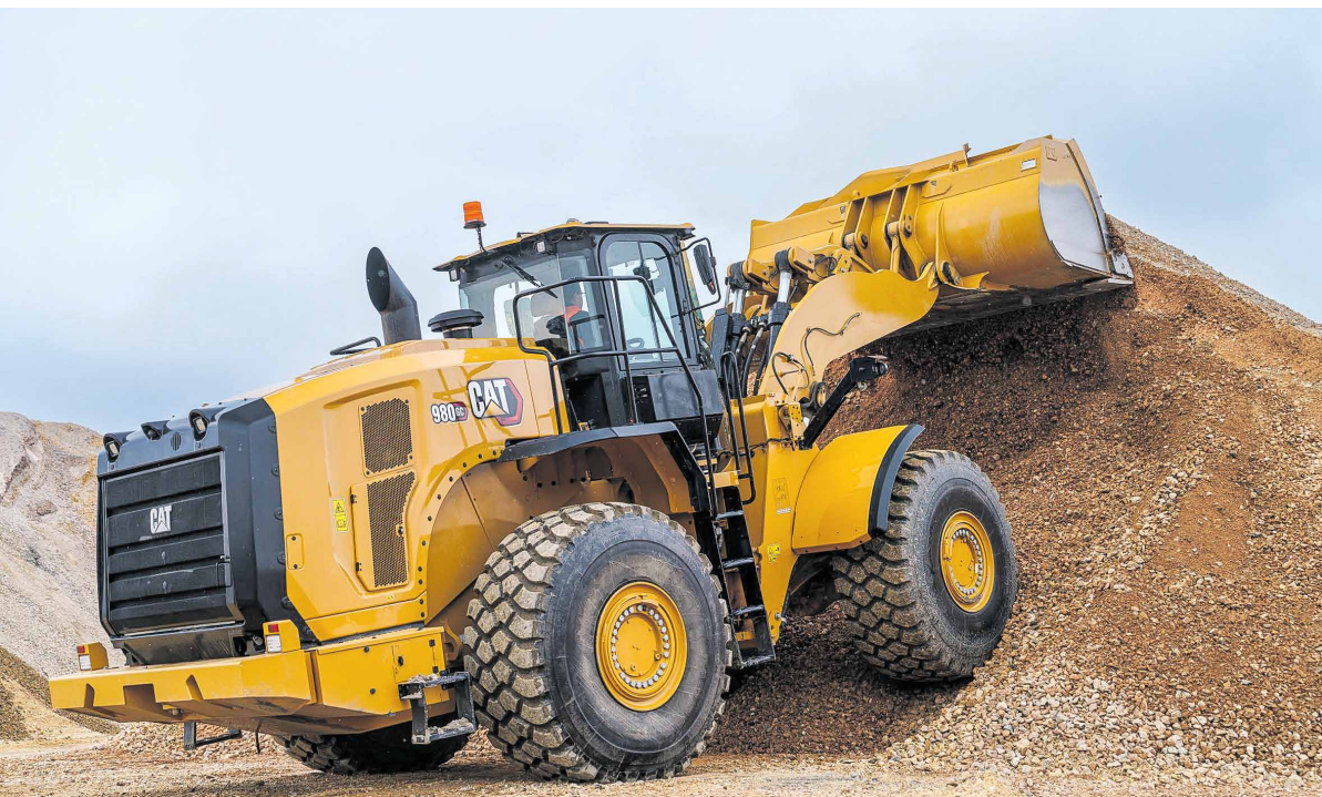
Der Cat 980 GC baut auf einer langen Tradition von zuverlässigen Baumaschinenkonstruktionen auf und setzt fort, was den Kern der mittelgroßen Radlader ausmacht: ein niedriger Kraftstoffverbrauch, eine Load-Sensing-Hydraulik sowie intuitive Bedienelemente.
