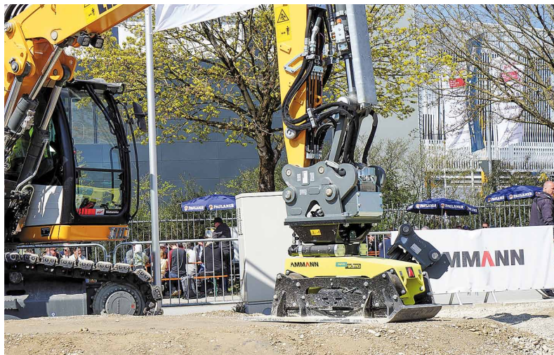
Neu in Design und Technik sind die großen Anbauverdichter von Ammann. Sie sind geeignet für Tiltrotatoren und daher gleichzeitig auch für beengte Verdichtungsarbeiten.
