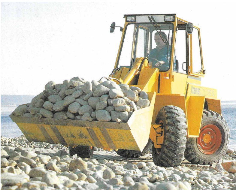
Neue Ära: Der 312 SL symbolisiert ab 1986 die Philosophie von Kramer und seine Vorteile auf der Baustelle, insbesondere durch die Vierradlenkung.
