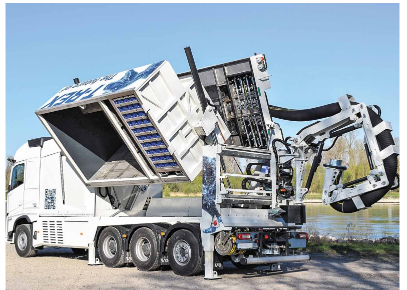
Die Reichweite des neuen Saugbagers Dino T-Rex ist mit dem verschiebbaren Evoslide-Kraftarm deutlich größer als zuvor. Auch das Design ist ergonomischer gestaltet.
