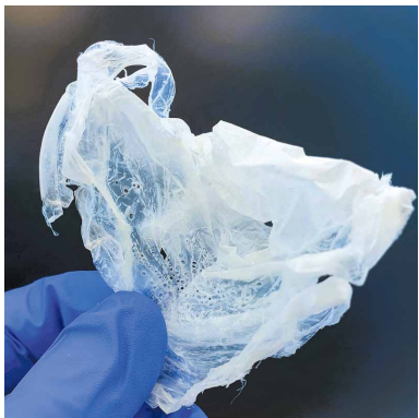
Klärwasser bildete den Ausgangspunkt für diesen Biokunststoff PHA. Fotos (2): Fraunhofer IGB
