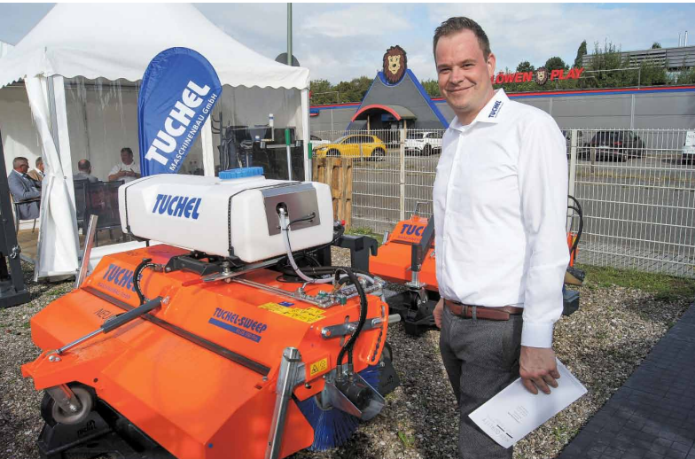
Wer durch das Freigelände der Nordbau lief, konnte feststellen, dass die Anbaugeräte von Tuchel an manchem Stand zu finden waren, die nicht von dem Hersteller selbst betreut werden. Denn sie lassen sich wie der neue „Tuchel-Sweep 590 Pro“ an vielen Lädern aufnehmen, wie Carsten Heilemann am Tuchel-Stand erläuterte. Neu ist ihm zufolge insbesondere, dass der Schmutzsammelbehälter ein integriertes drittes Stützrad bekommen hat. Ein Rasthebelsystem sorgt für die Höhenverstellung.
