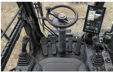
Der Kabineninnenraum des Mobilbaggers mit KI und Zwölf-Zoll-Instrumententafel. Foto: Develon
