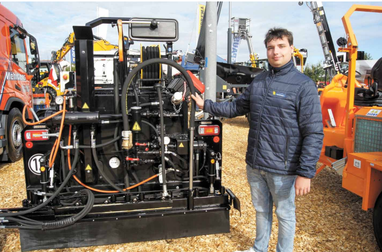
Schäfer-technik aus Fellbach bei Stuttgart überließ bei der Nordbau nichts dem Zufall und präsentierte in Neumünster seine Vorspritz-Bitumenmaschinen nahezu am gleichen Freigelände-Ort wie ein Jahr zuvor. Dennis Deichsel (im Bild) konnte zusammen mit Tim Reinhardt unter anderem die Vorspritzmaschine des Typs „BSM-SF 4-1000“ präsentieren. Die variable Spritzbreite kann bis zu drei Meter betragen. Eine Gasheizung regelt die Temperatur für den optimalen Einbau.
