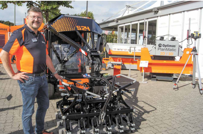
Optimas war mit seinen neuesten Pflasterverlege-Geräten bei der bauma dabei. Ähnlich wie dort hat Geschäftsführer Franz-Josef Werner auch bei der Nordbau die Weiterentwicklung der „PaveJet S24“ in den Mittelpunkt des Stands gerückt. Der Ersatz der Bedienleiste durch ein Siebenzoll-Display ermöglicht bessere Sicht. Die Maschine verlegt über 1.000 Quadratmeter Pflaster pro Tag. Dank einer niedrigeren Bauhöhe kann sie auch problemlos in Tiefgaragen eingesetzt werden.
