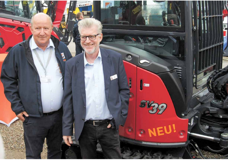
Oliver Blaha (links) und Ulf Böge zeigten den Messebesuchern das Angebot von HKL. Zu den wesentlichen Neuheiten auf dem Stand des Baumaschinenhändlers und -vermieters gehörte der Yanmar-Minibagger SV 39. Die Maschine der Vier-Tonnen-Klasse war mit einem Anbauverdichter von Ammann zu sehen und verfügt unter anderem über ein weiterentwickeltes Fahrzeug- und Bedienkonzept. HKL ist ein wachsender Anbieter mit neuen Niederlassungen in Celle, Hof und Wilhelmshaven.
