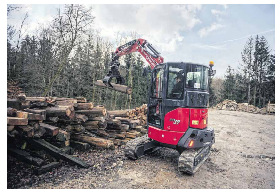
Der SV39 von Yanmar bietet bis zu 20 Prozent mehr Hubkraft als vergleichbar schwere Maschinen.
