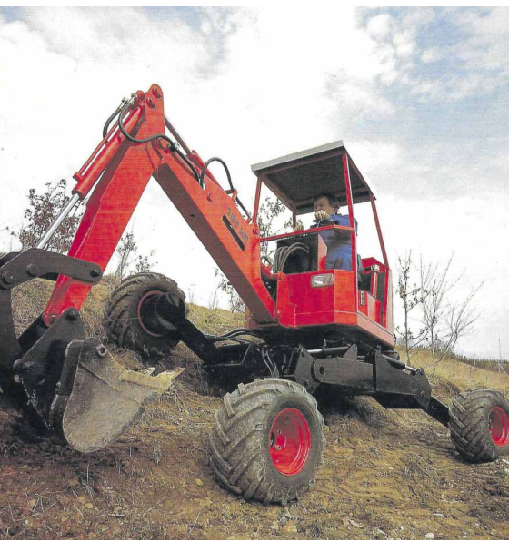
Nur kurze Zeit gab es den Neuson Pluto 2100 WD als Schreitbagger. Die Maschine gehört zu den ersten Minibaggern, die in Österreich entwickelt wurden. Foto: Werksbild/Archiv Verfasser
