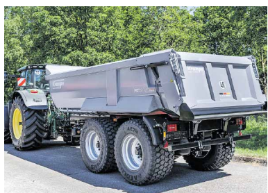
Der erste Krampe-Erdbaukipper mit hydraulischer Zwangslenkung.
