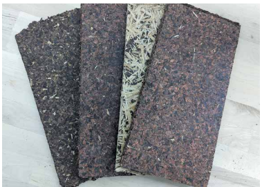
In Karlsruhe hergestellte Platten aus gepresster Baumrinde und Laub. Foto: DHBW/Lukas Walter
