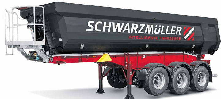
Die Vollaluminium-Segmentmulde für den Baustelleneinsatz mit drei Achsen.
